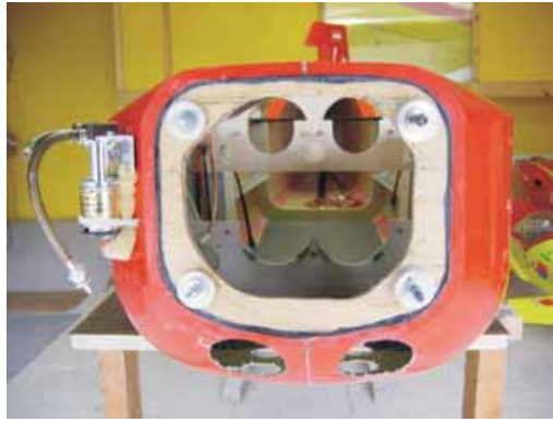
Blick von Vorne in den Rumpf mit der im Text beschriebenen Motorbefestigung. Links sieht man die Smokerpumpe mit den Anschlußschläuchen.
