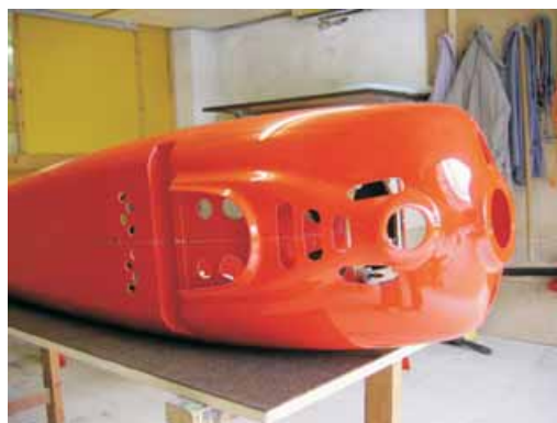
Der Innenausbau für Tanks und Schalldämpfer. Mit dem leichten ZDZ-Motor muß alles so weit wie möglich nach Vorne montiert werden, um nicht schwanzlastig zu werden.
