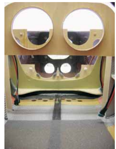
Der Innenausbau für Tanks und Schalldämpfer. Mit dem leichten ZDZ-Motor muß alles so weit wie möglich nach Vorne montiert werden, um nicht schwanzlastig zu werden.
