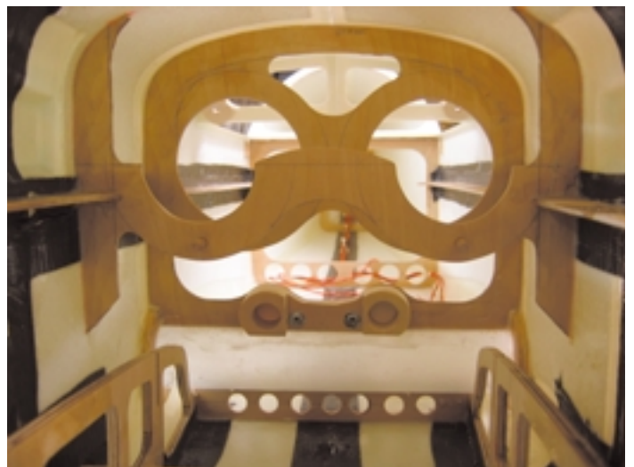
Der Rumpf von vorne mit den Fahrwerkspannten und den Kohlebändern. Gut zu sehen sind die Spanten für die Tanks, die Auspuffhalterungen und die Hülse für die Flächensteckung. Die seitlichen Verstärkungsleisten sind ebenfalls schon eingeklebt.
