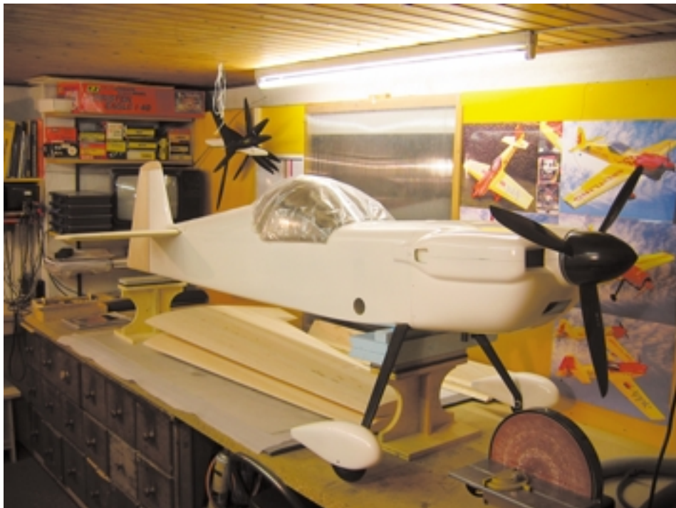
Erster Zusammenbau des Rumpfes ohne Flächen. Die Werkbank wird "voll". Die Cockpithaube und das EWD-Rohr der Fläche sind noch nicht fertig. Die Befestigung des lenkbaren Spornrades. Die Bohrungen am Rumpfboden sind für die Entlüftung der heißen Auspuffluft. Unten die EWD-Verstellung.
