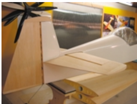
Einblick in die Seitenruderruflose mit diversen Versteifungen unmittelbar vor dem Verschließen. Das Servoansteckteil mit MPX-Stecksystem ist schon fertig montiert.
