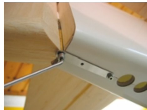
Erster Zusammenbau des Rumpfes ohne Flächen. Die Werkbank wird "voll". Die Cockpithaube und das EWD-Rohr der Fläche sind noch nicht fertig. Die Befestigung des lenkbaren Spornrades. Die Bohrungen am Rumpfboden sind für die Entlüftung der heißen Auspuffluft. Unten die EWD-Verstellung.
